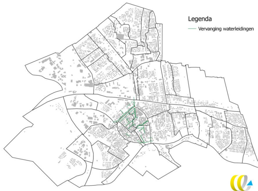
Figuur 22 - Geplande vervanging waterleidingen in Gouda
